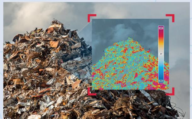
Temperatur-Fernüberwachung mit Thermalkamera
